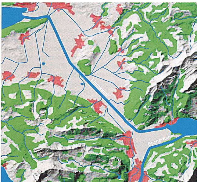
Linthkanal Grynau: Das Linthwerk ist ein komplexes System mit mehreren Binnenkanälen. Im Unterlauf liegt der Wasserspiegel beim Escher- wie beim Linthkanal über dem Niveau des Umlandes. (Bild Linthwerk)
