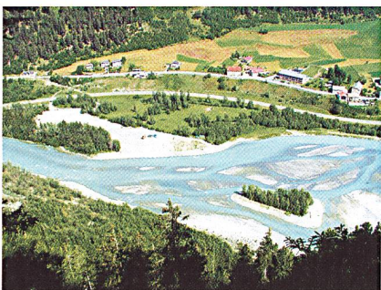
Aufweitung Inn: Durch eine rechtsseitige Aufweitung des Gerinnes im Kundertriet unterhalb von Mollis – wie hier am Inn bei Strada im Unterengadin – soll sich die Linth ihren Lauf wieder selber suchen können. (Bild: Tiefbauamt Graubünden)
