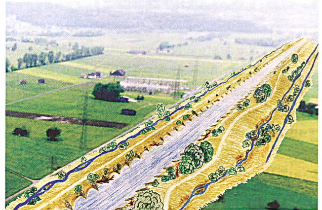
Giessen-Grynau heute/Giessen-Grynau Zukunft: Zwischen Giessen und Grynau wird der Linthkanal mit seinen Hintergräben umfassend umgestaltet. Dadurch wird einerseits der Hochwasserschutz wieder gewährleistet, andererseits eine weit reichende ökologische Aufwertung erzielt. (Grafik: habitat)
