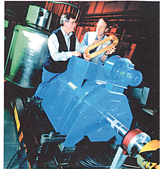
Elektromotor mit eiskaltem Herz: In Erlangen betreibt Siemens eine Synchronmaschine mit einer supraleitenden Läuferwicklung. Die Stromdichte ist etwa zehnmals so gross wie bei einer Kupferspule.
