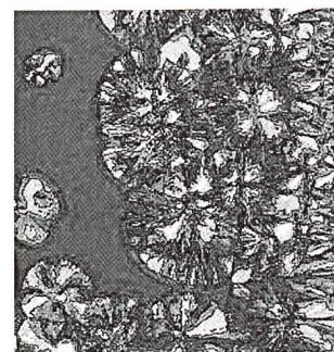
Mikroskopaufnahme eines kristallisierten Films des neuen Materials zwischen gekreuzten Polarisatoren.
