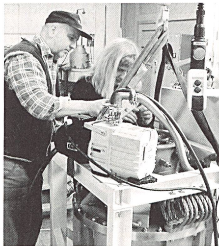
Schwungradspeicher wird getestet.
