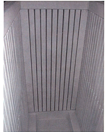
Bild 4 Vertikale Streuflussführung, «Kesselschirmung».
