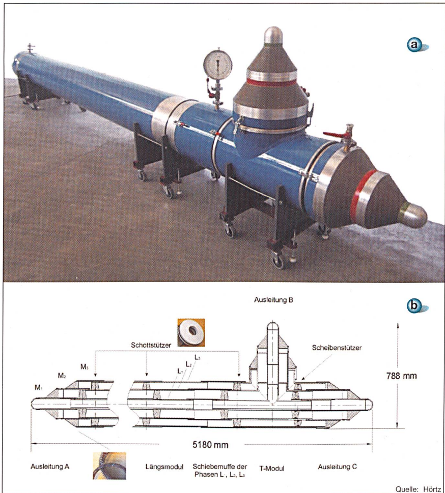
Bild 4 Trikoaxialer Rohrgasleiter in Konfiguration I Bild 4a: Prototyp; Bild 4b: technische Zeichnung
