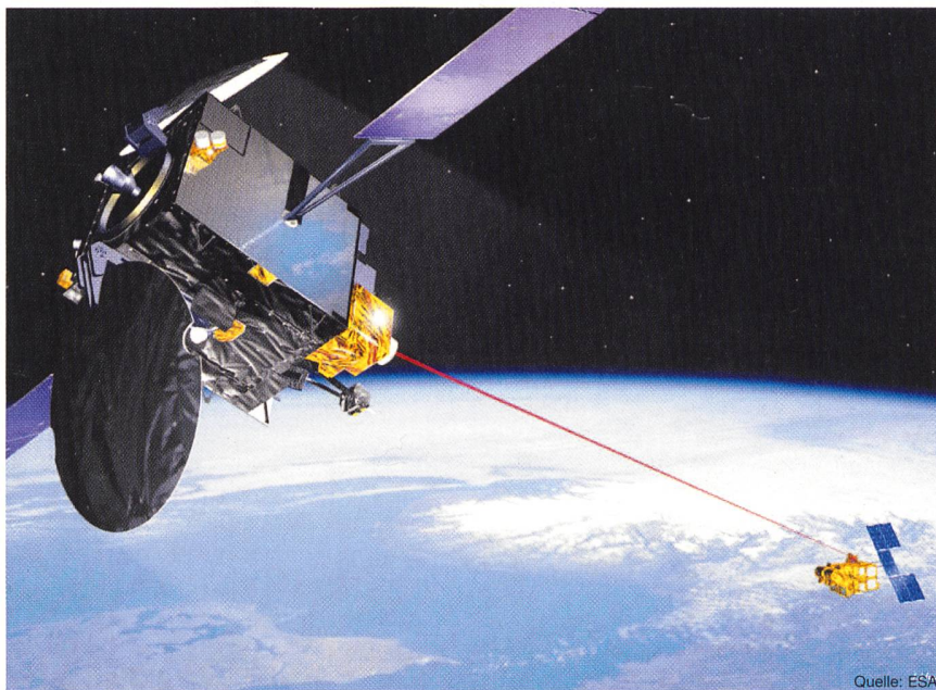
Bild 1 Die Satelliten Artemis und SPOT 4 kommunizieren optisch mit Hilfe des Silex-Systems
