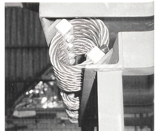
Bild 5 Bodenrahmen mit Drahtseilfeder-Elementen.
