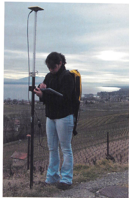
Mobile Vermessungsstation – station de mesure mobile
