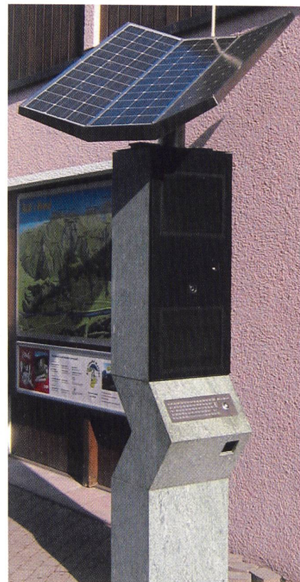
Eine autarke Kommunikationssäule für den öffentlichen Raum: der PV-Obelisk
