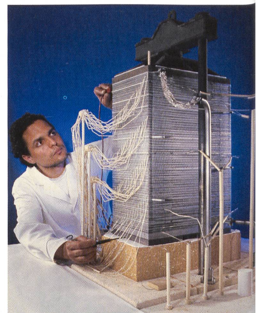
Der neue Brennstoffzellenstapel besteht aus 60 planaren Einzelzellen und liefert eine Leistung von 13,3 Kilowatt – Weltrekord (Fotos: Forschungszentrum Jülich).
