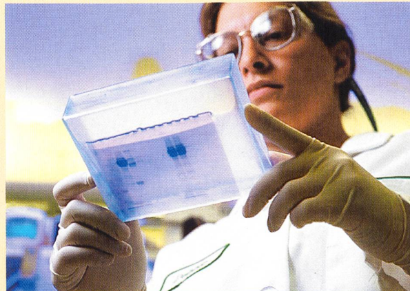
Die Gel-Elektrophorese gilt als leistungsfähige, universell einsetzbare Trennmethode bei qualitativen und quantitativen Fragestellungen. Sie ist z. B. Standardtechnik zur Auftrennung von Proteinen (Bild Schering).
