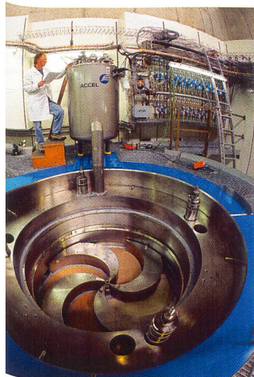
Das neuartige kompakte Medizin-Zyklotron des PSI wurde für die spätere Anwendung der Protonentherapie in Spitälern entwickelt, wiegt 90 Tonnen und hat einen Durchmesser von 3,2 Metern. Es kann Milliarden von Protonen (Wasserstoffkernen) pro Sekunde auf spiralförmigen Bahnen auf eine Geschwindigkeit von ca. 180 000 km pro Sekunde beschleunigen (60% der Lichtgeschwindigkeit; Bild PSI).
