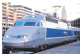
Hochgeschwindigkeitszug TGV (Höchstgeschwindigkeit: 300 km/h; Höchstleistung: 6450 kW; Bild SNCF)
