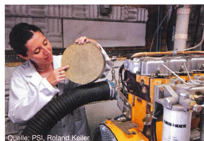
Die Chemiedoktorandin Gaia Piazzesi zeigt den wabenförmigen SCR-Katalysator, der mehr als 90 Prozent der Stickoxide im Abgasstrom entfernt. Rechts der Dieselmotor des Teststands.
