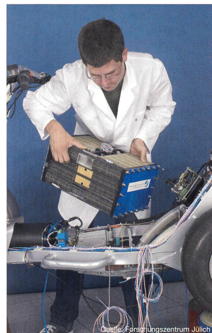
Der Brennstoffzellen-Stapel besteht aus 100 einzelnen Zellen
