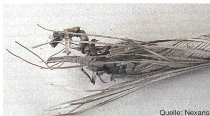
Bild 3 Teil der gerissenen Stelle
