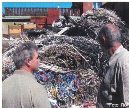
Berge von Elektrokabeln erheben sich temporär bei der Maag Recycling. Die täglich anfallende Menge von 2 Tonnen reicht aber noch lange nicht, um wirtschaftliches Recycling im Hause betreiben zu können. Dazu wären täglich 40 bis 50 Tonnen nötig.
