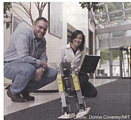
Quelle: Donna Coveney/MIT Der Roboter «Toddler» vom Massachusetts Institute of Technology (MIT) geht wie ein Mensch – vorgegeben durch das mechanische Design – und braucht darum nur wenig Energie.
