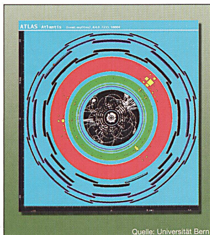
Bild 5 Eine simulierte Proton-Proton-Kollision im ATLAS-Detektor
