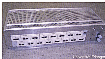
Bild 8 Die Empfangseinheit des Messsystems beinhaltet das Netzteil, die Messsignalempfänger und den Protokollumsetzer, der zwischen Hauptrechner und den 32 Messkopf-Controllern vermittelt
