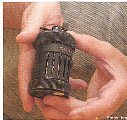
Die kleinste mechanische Rechenmaschine der Welt: Curta. Erfunden von Curt Herzstark (1902–1988). Stefan Beck hat Curt Herzstark persönlich gekannt und weiss vieles über den genialen Erfinder zu erzählen. Bis zur Produktionseinstellung 1969 wurden insgesamt 150 000 Curtas verkauft.
