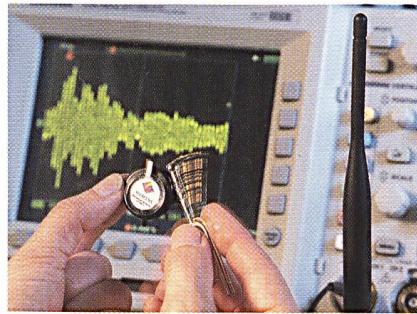
Batterie- und kabellose Sensoren, entwickelt bei Siemens Corporate Technology, überwachen zuverlässig technische Komponenten
