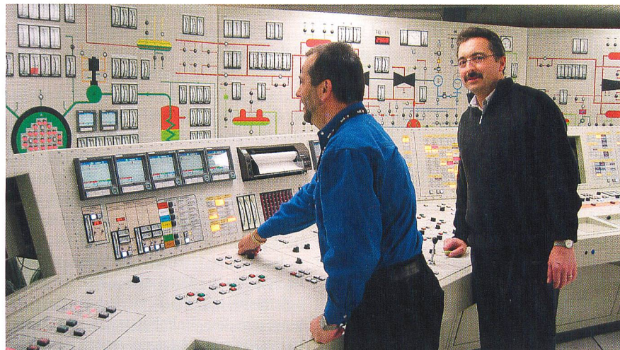
Der in Entwicklung begriffene Grosssimulator – er steht zurzeit noch beim kanadischen Hersteller in Montreal – wird mit Unterstützung durch KKB-Experten für den Einsatz im Kernkraftwerk Beznau vorbereitet (Bild: nok).
