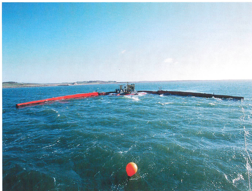
Der Test des 57 Meter langen und 261 Tonnen schweren «Wave Dragon» begann im März 2003 (Foto Wavedragon).
