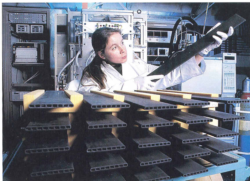
Die Festkeramik-Brennstoffzelle (SOFC) von Siemens Power Generation besteht aus einem Elektrolyten und zwei Elektrodenschichten in einer speziellen Röhrenkonstruktion. Diese Bauform benötigt im Gegensatz zu anderen Brennstoffzellentypen keine Dichtungen und ermöglicht eine Wärmeausdehnung. Bei einer Röhren-Brennstoffzelle strömt Luft durch das Innere der Zelle, während auf der Aussenseite Brennstoff vorbeifliesst. Bei hinreichend hohen Temperaturen wird der Luftsauerstoff ionisiert, und die entstehenden Ionen strömen durch den Elektrolyten zur Aussenseite der Zelle, wo sie mit dem Brennstoff rekombinieren. Da es sich um eine elektrochemische Reaktion handelt, werden Elektronen freigesetzt; wenn entsprechende Anschlüsse vorhanden sind, können diese als elektrischer Strom durch einen externen Stromkreis wandern (Bild Siemens).
