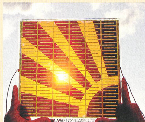
Die Herstellung der Farbstoffsolarzellen erfolgt durch einen einfachen Siebdruck.
