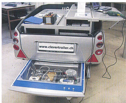
Der Brennstoffzellenstapel generiert 230 Volt Wechselstrom für unterwegs
