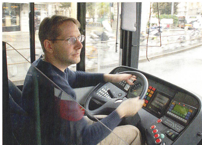
Betriebsleiter Henri-David Philippe gefällt der Chauffeurarbeitsplatz mit dem höhenverstellbaren Armaturenräger.
