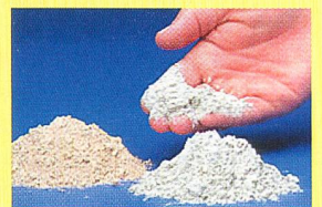
Forschungsobjekt CO 2 -Speicherung: hier minerale Abtrennung mit Magnesium-Silikat zur Speicherung als Karbonat (Bild ECN).
