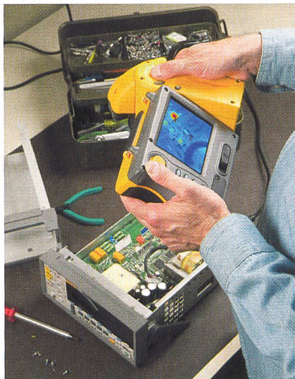
Wärmebildkamera von Fluke im Einsatz
