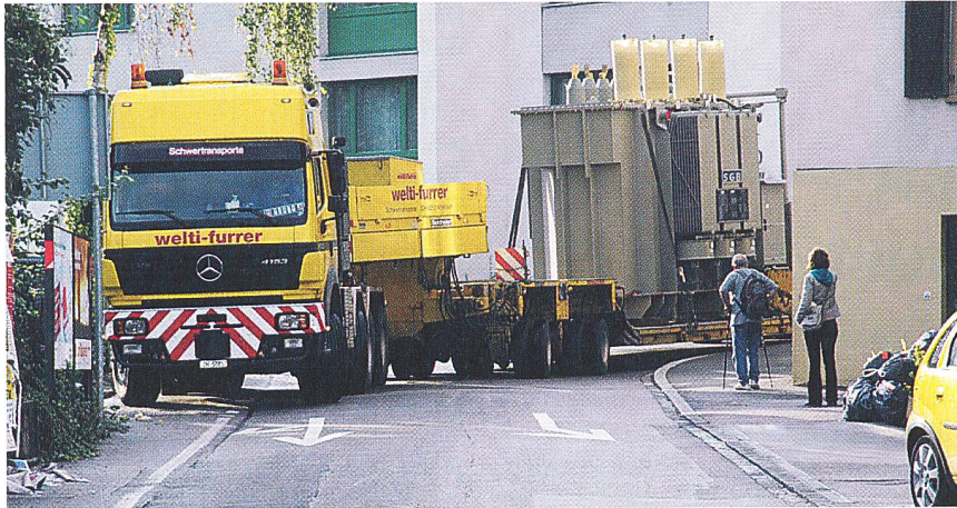
Eine 530 PS starke Sattelzugmaschine zog den sechsachsigen Tiefgangauflieger mit der schweren Last nach Liestal. Manchmal wurde es dem 26,6 Meter langen Schwertransport etwas eng (Bild: ebl).
