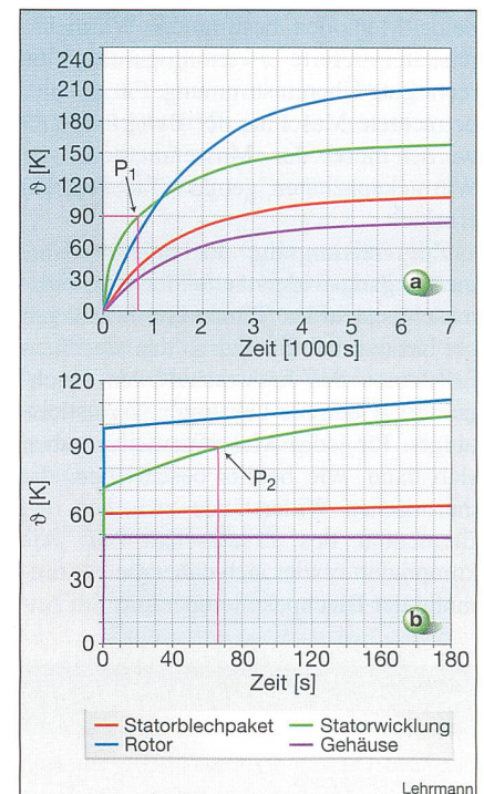
Bild 8 Temperaturverlauf der Maschine mit 1,5-fachem Bemessungsstrom
