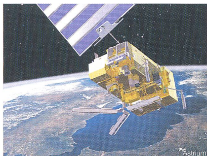
Metop umrundet die Erde in 800 Kilometer Höhe und liefert genaue Messdaten über Temperatur und Feuchtigkeit
