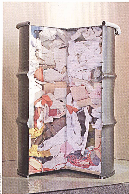
Beim Betrieb der Kernkraftwerke fallen unter anderem Schutzanzüge, Schuhe, Putzmaterial, Folien und kontaminierte Metallteile und Luftfilter als schwachaktiver Abfall an.
