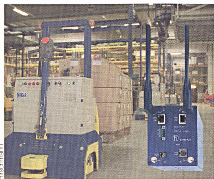
Der intelligente Hubstapler ist drahtlos vernetzt.
