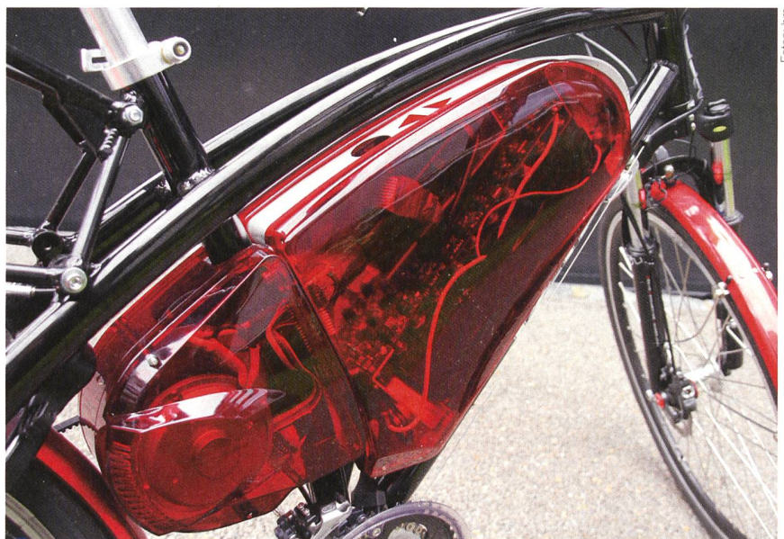
«Durch»-Blick ins Powerset des Dolphin: links Motorunit (Antrieb mit Zahnriemen aufs Hinterrad), rechts die Powerbox mit den Akkus, der Steuerung und dem integrierten Ladegerät.
