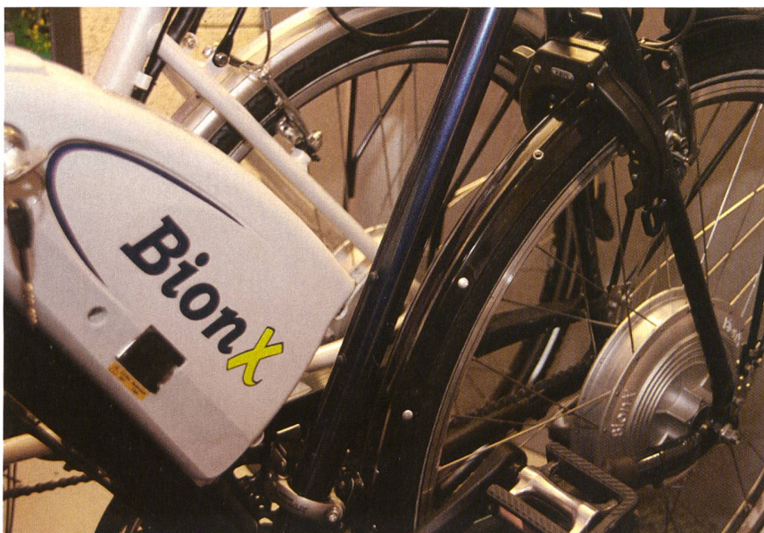
Das BionX-Set (Bild: Akkubox, Nabenmotor im Hinterrad) lässt sich in fast jedes Fahrrad einbauen.
