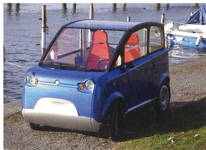
Prototypenfahrzeug, um zu zeigen, dass 350 kg für ein Elektromobil reichen.
