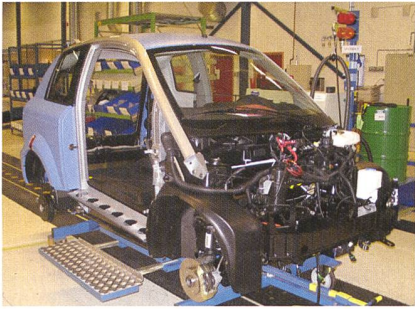
Rohbau mit Zellstruktur und Aufprallschutz.
