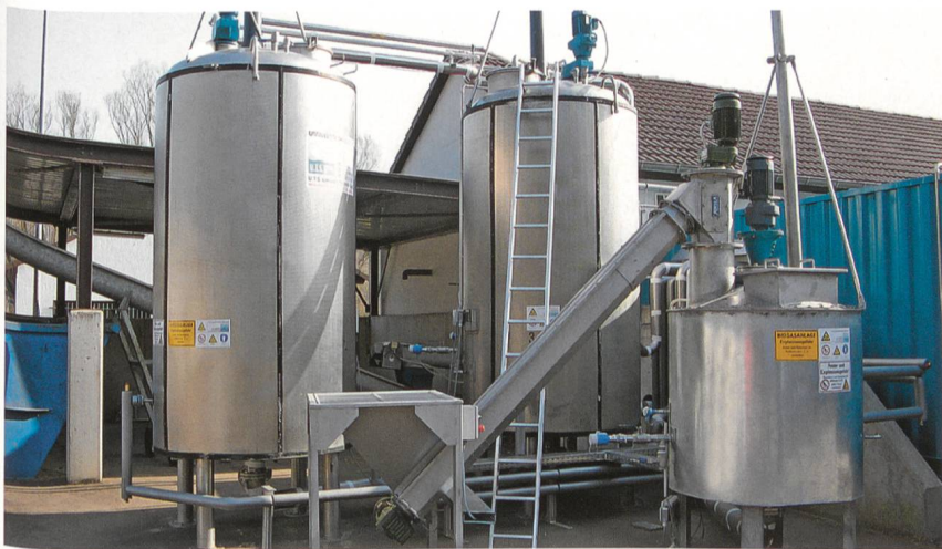
Die neue Biogasanlage lässt sich erstmals ausschliesslich mit Reststoffen, etwa Maisstroh, betreiben. Die Zugabe von Nahrungsmitteln ist unnötig.
