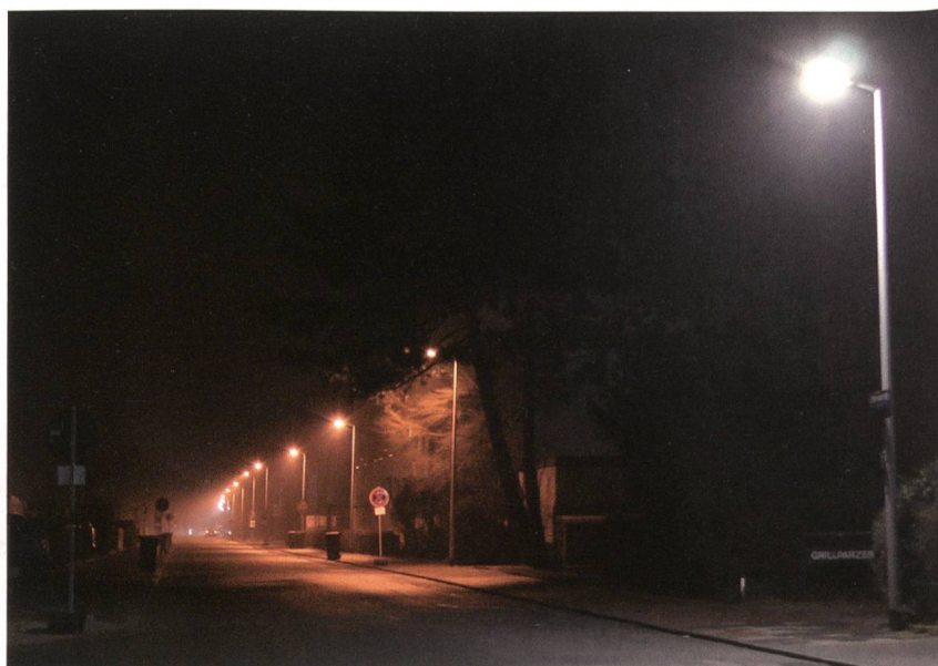
Bild 2 Teststrecke in der Nacht (Ausschnitt), Abschnitte von links nach rechts LED, HST, SON-H, HME.
