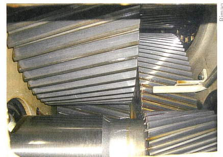
Roues dentées d'une éolienne de 2 MW.
