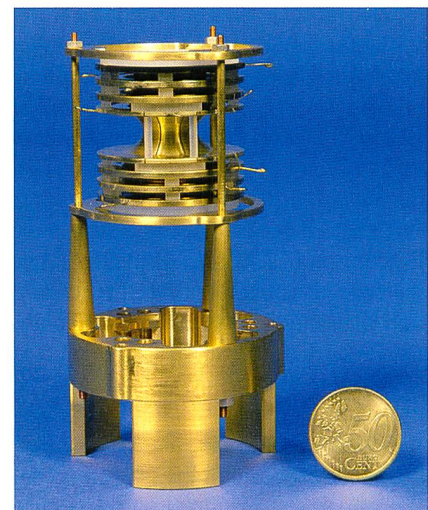
Eine Penningfalle kann elektrisch geladene Teilchen fangen und speichern.
