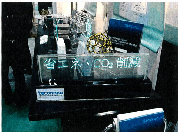
Bild 7 KNR-Feldemissionsanzeige. Die KNR-Feldemissionstechnologie kann auf Glassubstraten angewendet werden, was mit keiner anderen Flachbildschirmtechnologie möglich ist.
