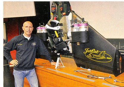
Yves Rossy mit dem aktuellen Prototyp. Die 4 Triebwerke liefern einen Schub von 88 kg und ermöglichen einen Steigflug mit 180 km/h.
