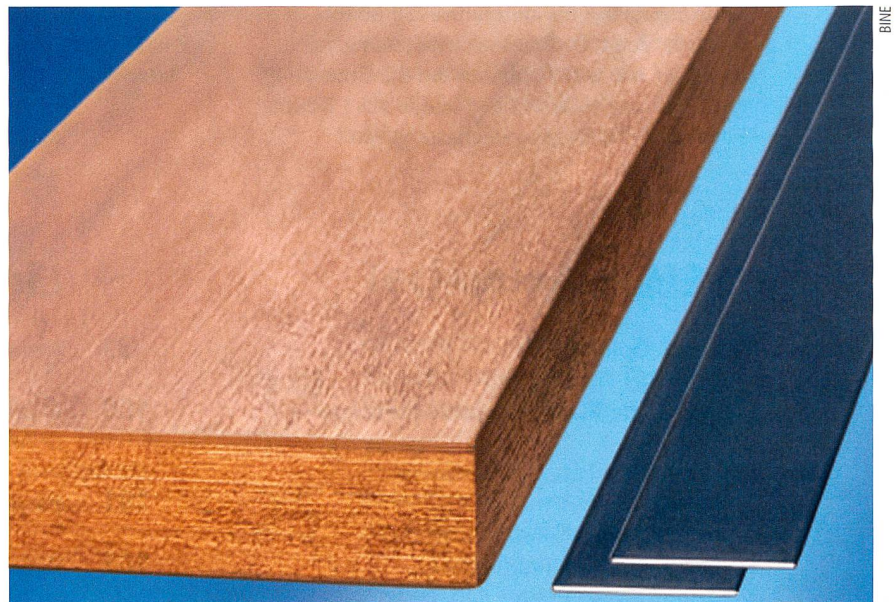
Neuer Supraleiter (rechts) leitet verlustfrei die gleiche Stromstärke (200 A) wie das Cu-Band (links).
