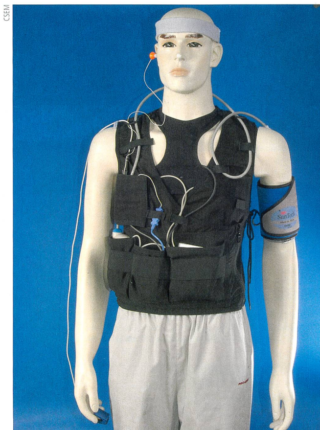
Figure 1 Le système LTMS permet de mesurer simultanément un grand nombre de signaux physiologiques (la figure représente le système complet avec toutes les options).
