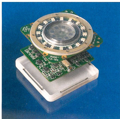
Figure 3 « Electrode-captur » qui, placée sur le haut du sternum, mesure simultanément une dérivation ECG, la S_pO_2 , la température corporelle et l'activité/posture du sujet.
