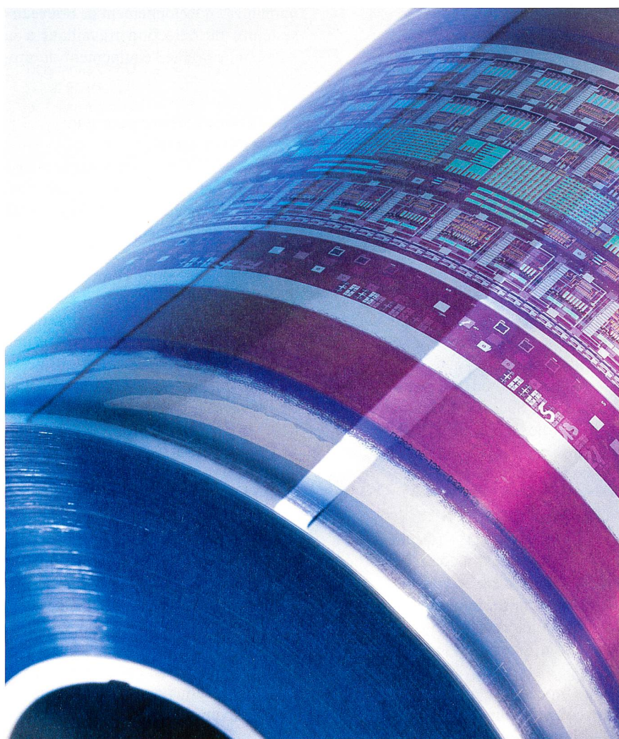
Figure 6 Electronique imprimée en bobine. Les couches conductrices et semi-conductrices alternées composent un circuit électrique utilisé comme transpondeur RFID.
