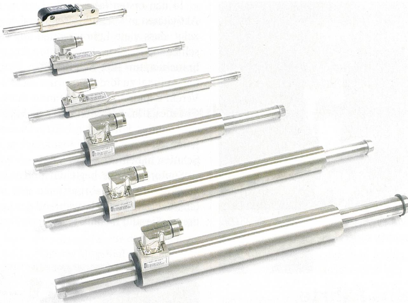
Bild 3 Industrielle Linearmotoren weisen mit der zylinderförmigen Bauform ähnliche Abmessungen wie Pneumatikzylinder auf und werden in bestehenden und neuen Konstruktionen aus diesem Grund häufig als Ersatz von pneumatischen Antrieben eingesetzt.
