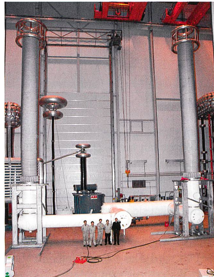
Die für China entwickelte 1100-kV-GIS-Schaltanlage demonstriert die Leistungsfähigkeit von GIS-Schaltanlagen.
