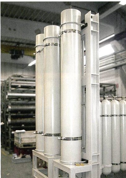
Sonocontrol 14 von aussen platzsparend am Kolbenspeicher montiert.
