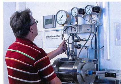
Druckprüfung zur Ermittlung des IP-Schutzes.
