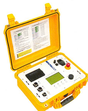
Das Tettex TTR 2796 erreicht eine Genauigkeit von bis zu 0,03 %.
