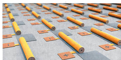
Ultradünne Schichtsysteme wickeln sich von selbst zu kleinen Energiespeichern auf.
