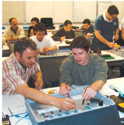
Schutzmassnahmenprüfung an Messmodellen.
