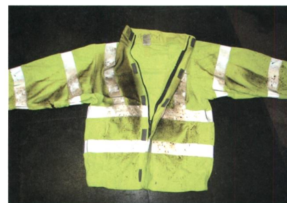
Swiss-ARC-Fleecejacke nach bestandem Lichtbogen-Test.
